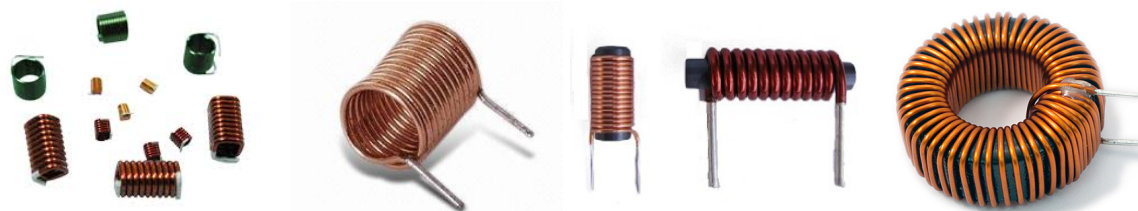
Figur 44 – Små spoler for printkort, en spole uden kerne, to spoler med stavformet kerne og en toroid spole hvor den ringformede kerne danner en lukket sløjfe for magnetfeltet (Wikipedia).
