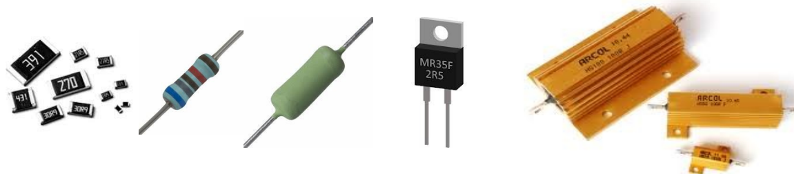
Figur 5 – SMD metalfilm indtil 0,5 W (Yaego). SFR25H af metalfilm på 0,5 W og AC01 trådviklet modstand på 1 W (Vishay). Modstand i TO-220 hus på 20 W for montage på køleplade (MQEC). Trådviklede modstande i cement for 10 til 100 W ved montage på en køleplade (Arcol).
