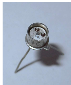
Figur 33 – Opbygning af en NPN transistor som fx BC547B med et billede af en lignende transistor BC109C hvis metalhus er åbnet så den lille chip ses. 14
