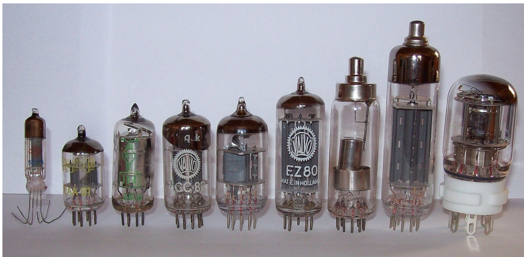
Figur 383 – Elektronrør benytter indkapsling i en lufttom glaskolbe og katoden skal opvarmes for at udsende elektroner (Wikipedia).
