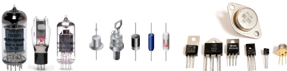
Figur 2 – De aktive komponenter radorør, diode og transistor (Wikipedia).
